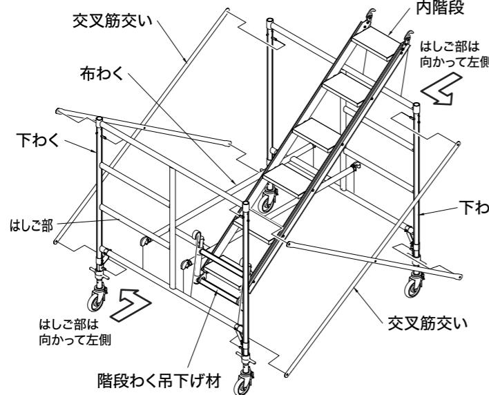
STEP 3 2.5段セット以上には、必ずアウトリガーを取り付けてください。
