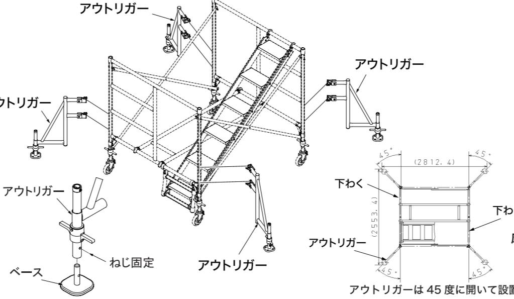
STEP 4 中わくを取付けます。(2段~3段セット)
