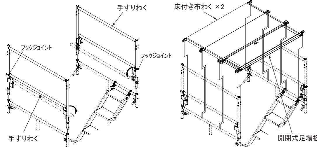
※開閉式足場板は、内階段の上部の位置で取手が内側にくるように取付けます。
