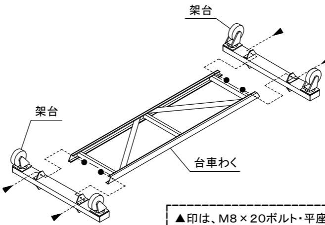
【3】【1】【2】で仮止めしたものをボルト・ナットで左右2ヶ所ずつ仮止めしてください。
