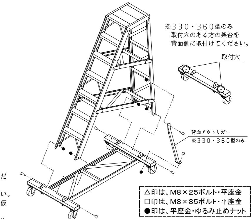
【2】階段と天板と背面わくと布わくをボルト・ナットで仮止めしてください。
