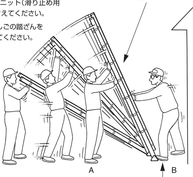
滑り止めユニット(滑り止め用端具)部分を足で押さえる
