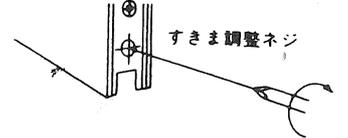
⑪引戸障子の下部にある戸車の高さを⊕ドライバーにより調節し、引戸障子と支柱の間隙をなくして下さい。
