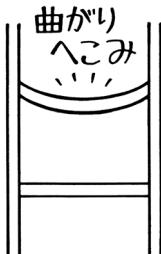
④各部の接合部に割れやいちじるしい腐食がありませんか。また、取り付け部品の破損・脱落・変形・磨耗・いちじるしい腐食がありませんか。ある場合は、絶対に使わないので廃棄してください。
