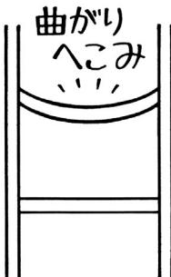
④各部の接合部に割れやいちじるしい腐食がありませんか。また、取り付け部品の破損・脱落・変形・磨耗・いちじるしい腐食がありませんか。ある場合は、絶対に使わないので廃棄してください。
