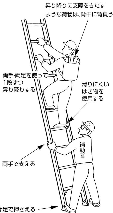
滑り止めユニット(滑り止め用端具)部分を片足で押さえる
