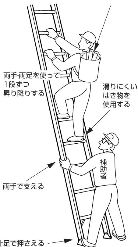
滑り止めユニット(滑り止め用端具)部分を片足で押さえる
