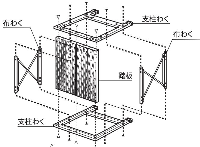
▲の方向からボルト(M8×20)及び、ばね座金で止める
