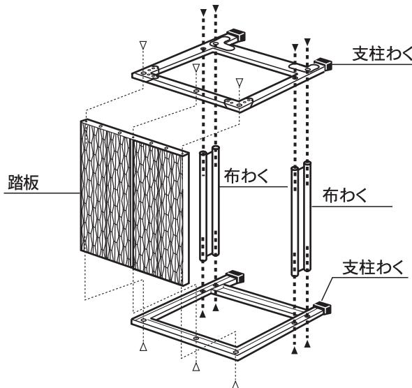
▲の方向からボルト(M8×20)及び、ばね座金で止める
