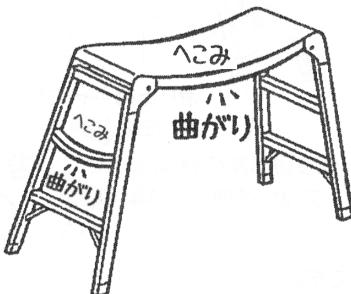
④ 各部の接合部に割れやいちじるしい腐食がありませんか。また、取り付け部品の破損・脱落・変形・磨耗・いちじるしい腐食がありませんか。ある場合は、絶対に使わないので廃棄してください。
