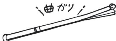
③ 各部の接合部に割れやいちじるしい腐食がありませんか。また、取り付け部品の破損・脱落・変形・摩耗・いちじるしい腐食がありませんか。ある場合は、絶対に使わないで廃棄してください。
