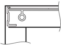
▲の方向からボルト及び、ばね座金で止める
