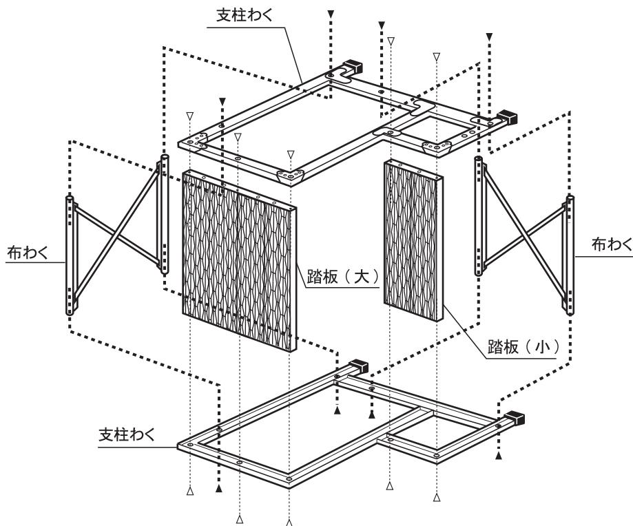
▲の方向からボルト(M8×20)及び、ばね座金で止める
