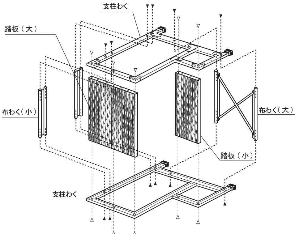
▲の方向からボルト(M8×20)及び、ばね座金で止める
