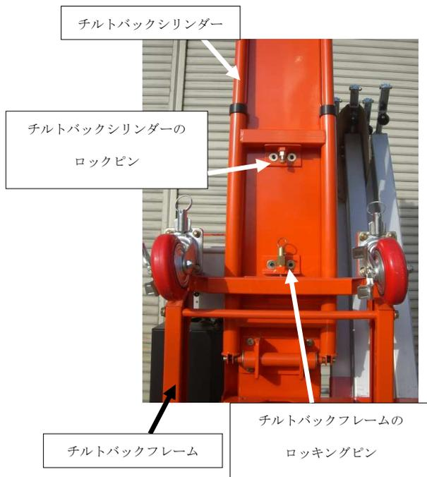
3) チルトバックシリンダーをしっかりと支えながらロックピンを引き、チルトバックシリンダーを下げます。チルトバックシリンダーの先をチルトバックフレームのブラケット部分に合わせてロックします。
