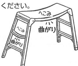
④各部の接合部に割れやいちじるしい腐食がありませんか。また、取り付け部品の破損・脱落・変形・磨耗・いちじるしい腐食がありませんか。ある場合は、絶対に使わないと廃棄してください。
